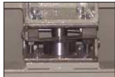
Dettaglio del vincolo e della cella di carico. Load cell and mounting accessories detail
